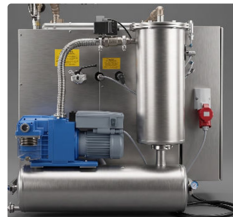
Die Vakuumpumpe und der Kondensator
